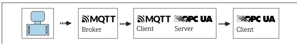
図 2 MQTT ブローカー、OPC UA サーバー、および TLS 暗号化を使用したセル無線通信。
