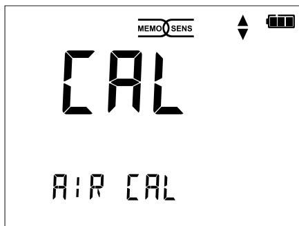
Kalibrierung Sauerstoff – Schritt 1 (Kalibrierung an Luft)
