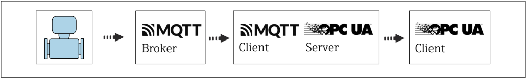
2 Подключение к сотовой сети обеспечивается программой-брокером MQTT, сервером OPC-UA и шифрованием TLS.
