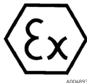
Figura 4. Etiqueta ATEX para uso em áreas classificadas
