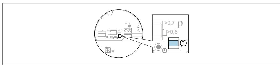
**29 Position du bouton pour le test de fonctionnement sur les électroniques FEL61/62/64/64DC/67/68**
