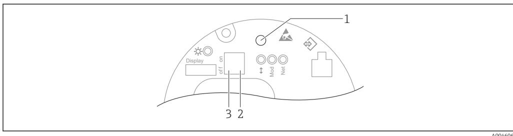
Fig. 2.1 Tecla de configuración y microinterruptores en el módulo del sistema electrónico (FEL60P), Ethernet-APL
