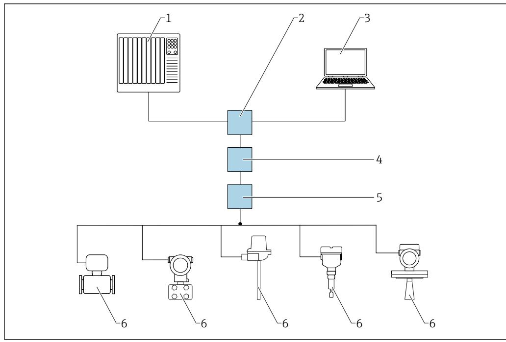
■ 24 Opciones para la configuración a distancia a través de la red PROFINET sobre Ethernet-APL: topología en estrella
