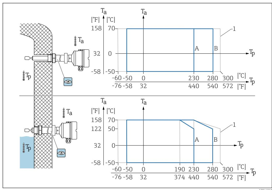
■ 38 Temperatura ambiente admisible  $T_a$  en la caja en función de la temperatura de proceso  $T_p$  en el depósito
