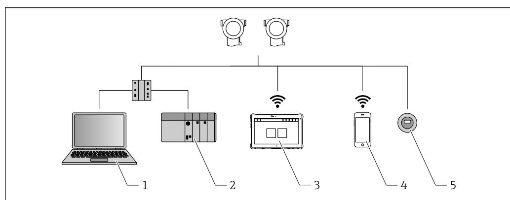
30 Opciones de configuración a distancia mediante protocolo PROFINET
