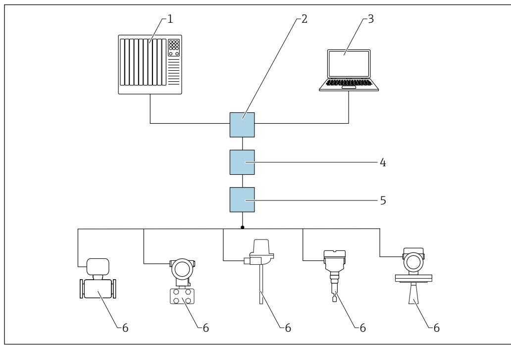
■ 28 Opciones para la configuración a distancia a través de la red PROFINET sobre Ethernet-APL: topología en estrella
