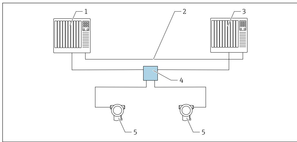
Fig. 29 Ejemplo del diseño de un sistema redundante (S2): topología en estrella
