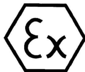
Figure 4. Label ATEX pour l'utilisation en zone explosible
