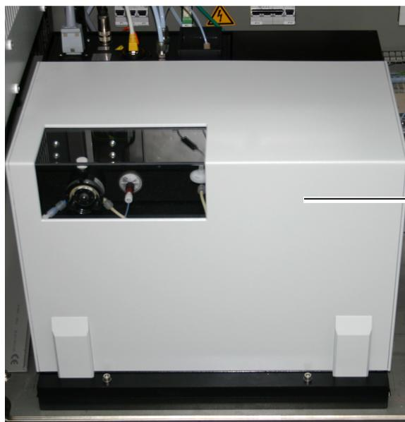
Coperchio del generatore del gas di prova CALSIC300
