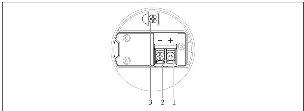
図 6 端子部の接続端子と接地端子
