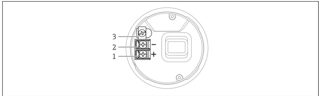
図 5 端子部の接続端子と接地端子
