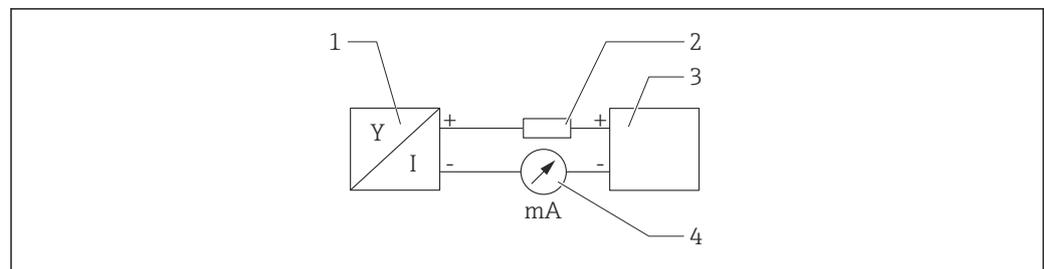
図 4 HART 接続のブロック図
