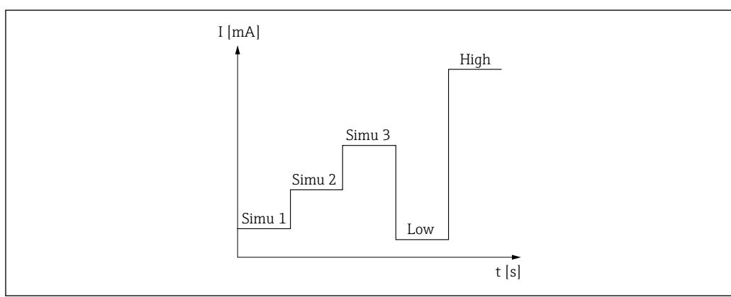
图 14 电流回路测试曲线
