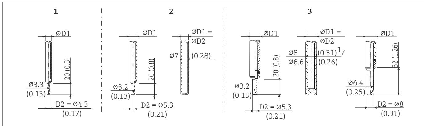
图 13 保护套管末端类型（缩径型、直型、锥型）
