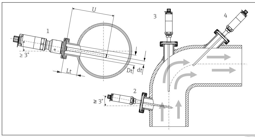
图 2 安装在工艺管道中
