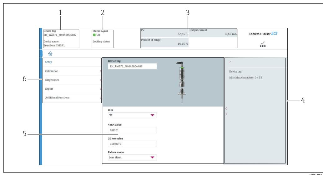
图 7 用户界面，通过 HART 通信显示设备信息
