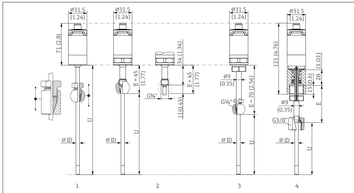
1 温度计, 不带延长颈, 通过 TK40 活动卡套安装, 球面螺纹+柱螺纹, 芯子直径 ( $\varnothing$ ID) = 6 mm
