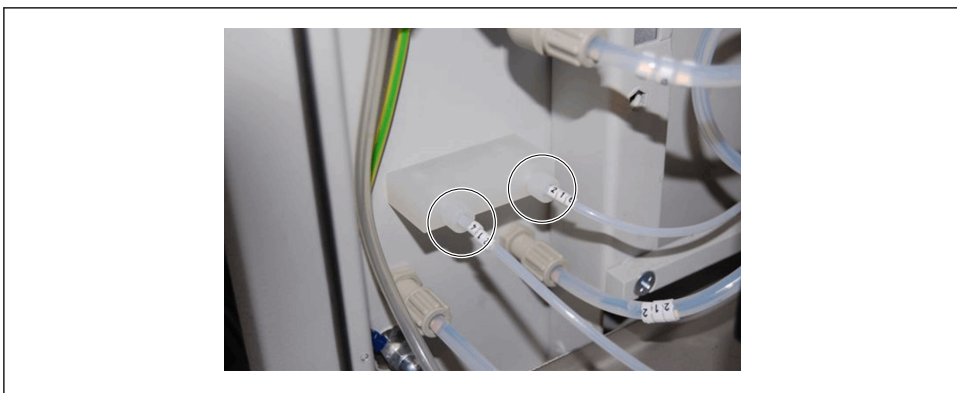
40 Verschraubung Kurzgewinde \frac{1}{8} " \times 28UNF ETFE am Adapter Kondensatablass für Säurezuführung
