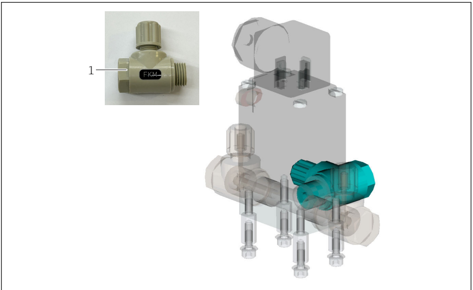
12 Winkelschwenkverbindungen am 3/2-Wege- Magnetventil
