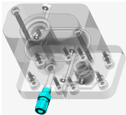
25 Verschraubung D 4/6 × G 1/8" PP am Heizfilter
