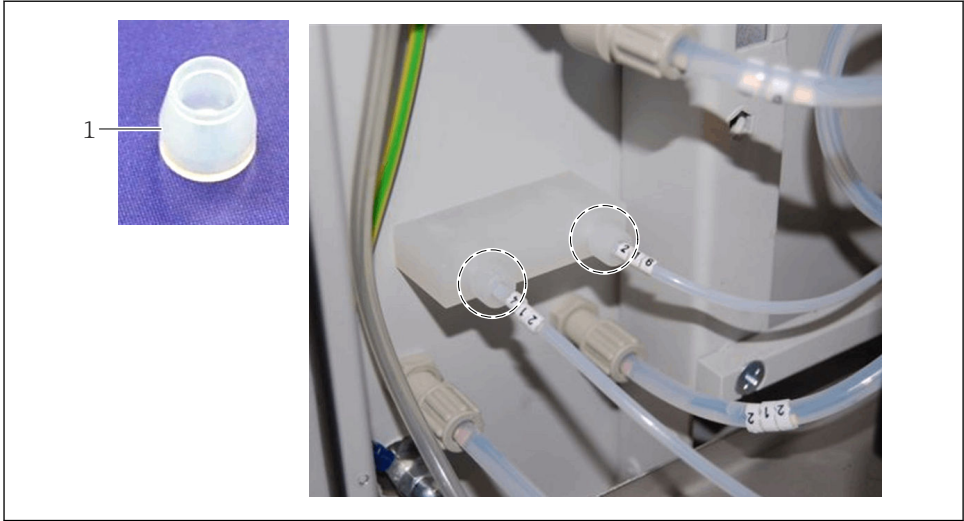
41 Konus für Verschraubung \frac{1}{8} " \times 28UNF ETFE am Adapter Kondensatablass für Säurezuführung
