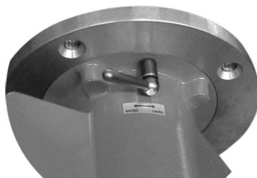
Abbildung 27: Hebel der Verschlussvorrichtung
