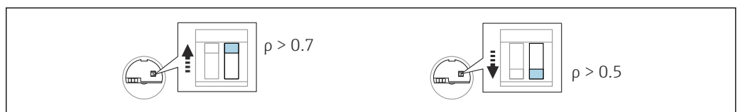
56 Posición del interruptor en el módulo del sistema electrónico para densidad
