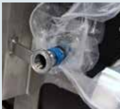
Einwegarmatur bei Auslieferung (dargestellt ohne Abdeckkappe)
