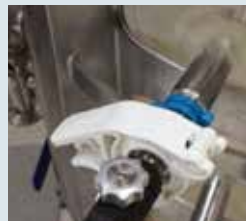
Angeschlossen an wiederverwendbares Raman-Optiksystem für Single-Use-Anwendungen
