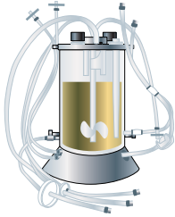
Single-Use-Bioreaktor für die Prozessentwicklung (Labormaßstab)
