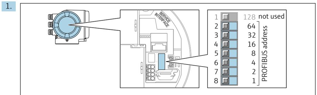
Die gewünschte Geräteadresse mittels der DIP-Schalter im Anschlussklemmenraum einstellen.
