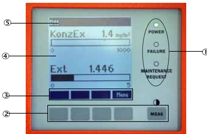
Rys. 60: Elementy funkcjonalne wyświetlacza LCD
