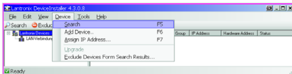
Rys. 48: Wyszukiwanie podłączonych elementów
