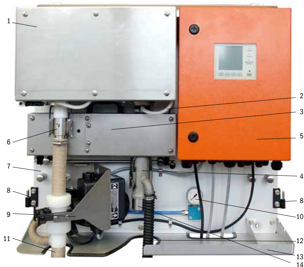
Rys. 8: Zespół przetwarzania (bez osłony atmosferycznej, z opcjonalnym płukaniem i osłoną dolną)
