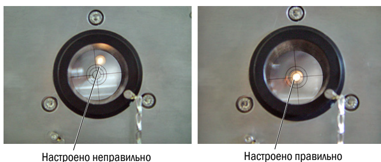
Рис. 20: Оптическая настройка на окне юстировочной мишени
