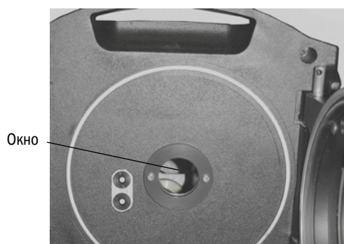
Рис. 35: Окошко приемопередающего блока (блока отражателя соответственно)
