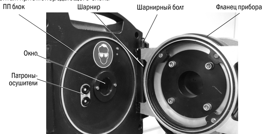
Рис. 23: Монтаж приемопередающего блока
