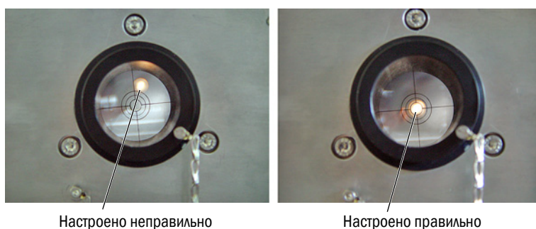
Рис. 7: Индикация оптической выверки - в окошке юстировочной мишени
