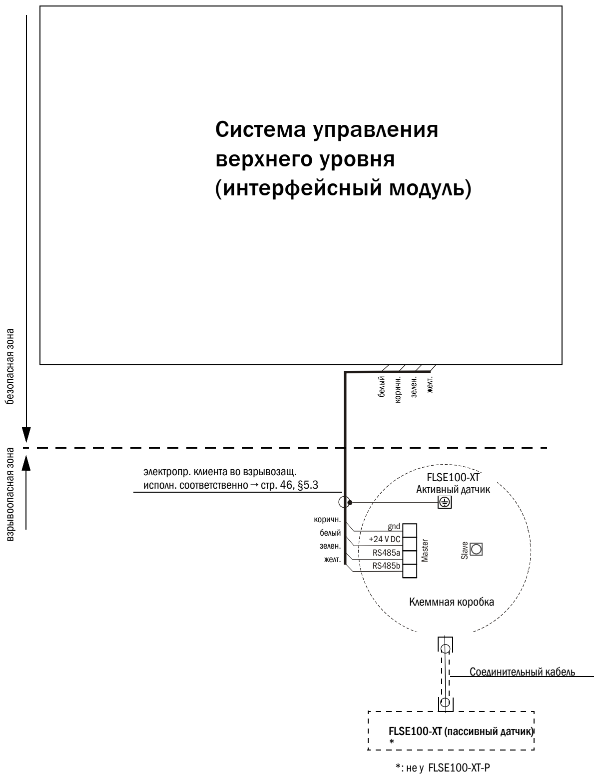
Рисунок 45 Электропроводка приемопередающих блоков
