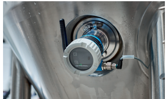
Der Fermentation Monitor QWX43 von Endress+Hauser wird direkt am Gärtank angebracht.
