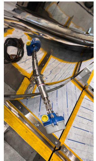
iTHERM ModuLine TM131 eingesetzt im PD-Mischer
