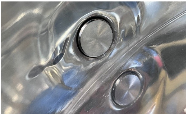
In der Wand des Mixers montierter Sensor mit extrem geringer Eintauchlänge
