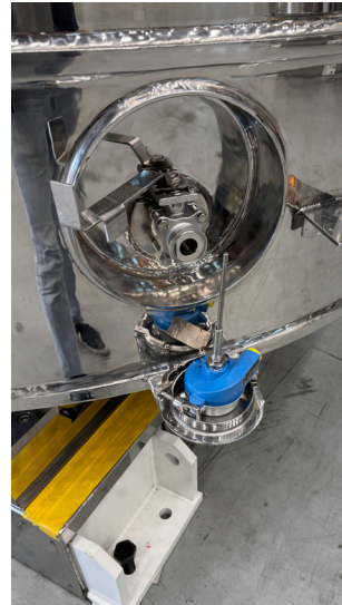
iTHERM ModuLine TM131 eingesetzt im PD-Mischer
