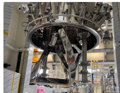
Offenes Mischwerk mit Rührwerk (Planetenmischer)
