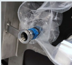
納入時の使い捨てフィッティング (キャップは図示せず)
