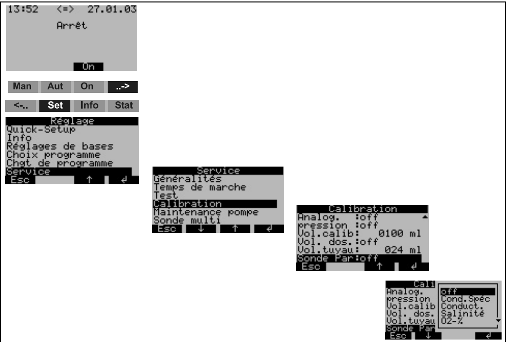
Fig. 20: Etalonnage de la sonde multiparamètres
