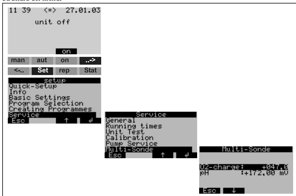
Fig. 21: Controllo della misura di pH (Sistema controllo sensore)
