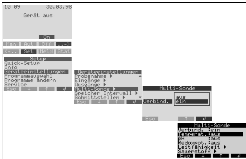
Abb. 23: Inbetriebnahme der Multiparametersonde (optional)
