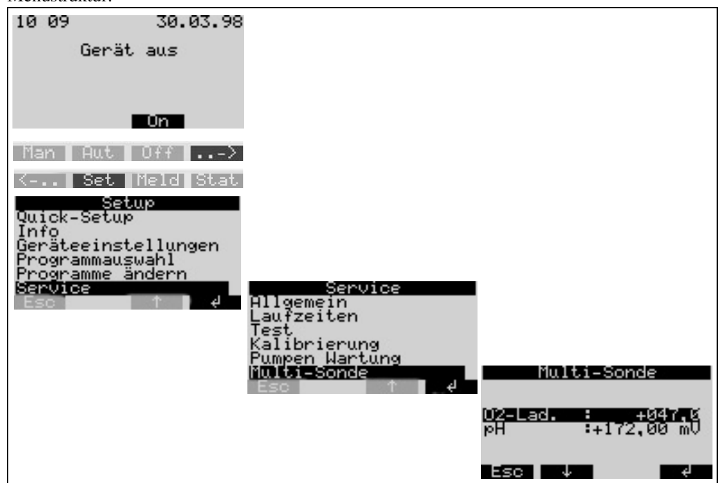
Abb. 22: Kontrolle der Sauerstoffmessung (Sensor-Check-System)
