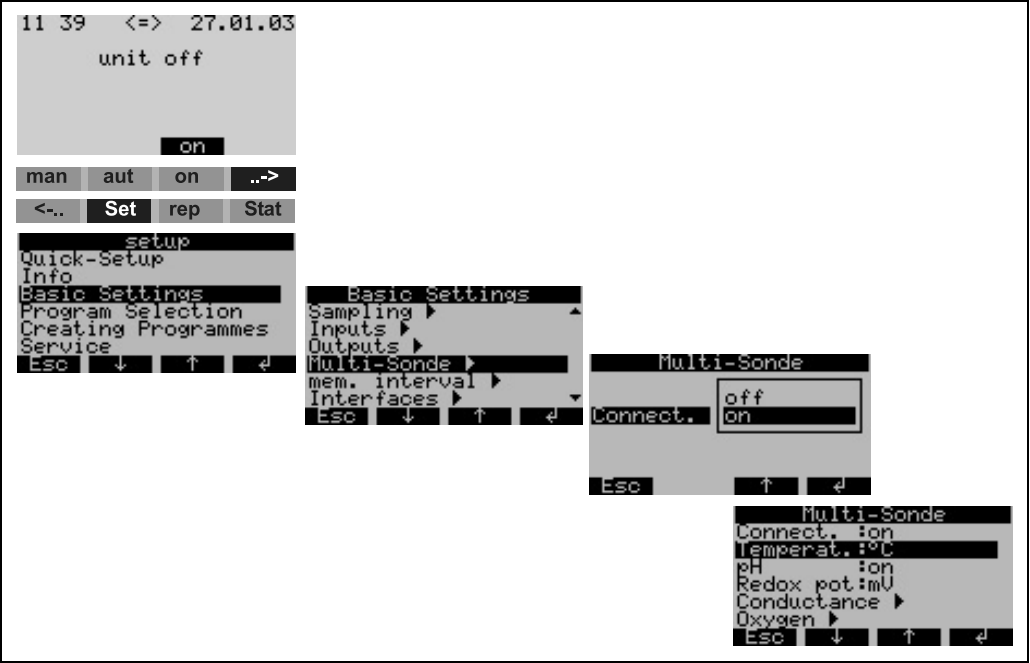
Fig. 23: Messa in servizio della sonda multiparametrica (in opzione)
