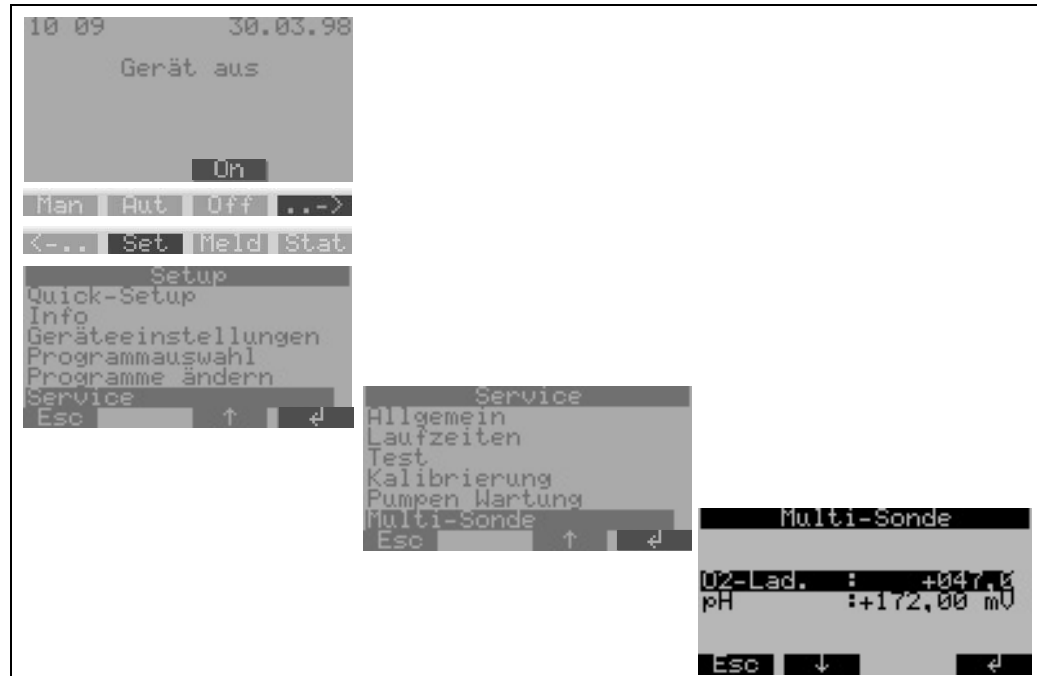
Abb. 21: Kontrolle der pH-Messung (Sensor-Check-System)
