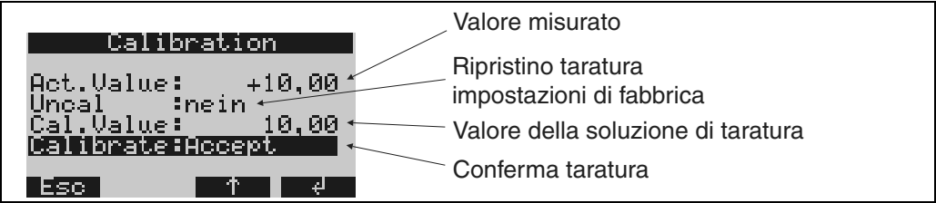
Fig. 20: Taratura della sonda multiparametrica
