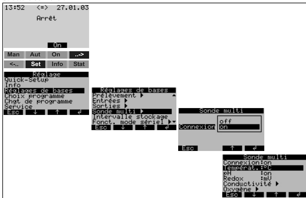
Fig. 23: Mise en service de la sonde multiparamètres (en option)
