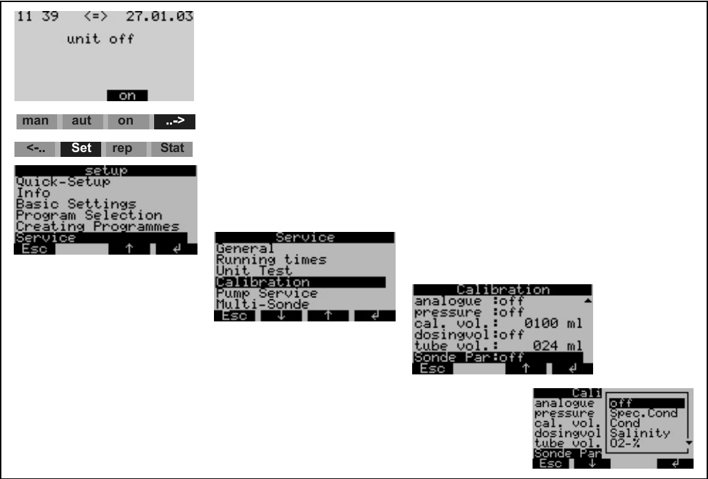
Fig. 20: Taratura della sonda multiparametrica
