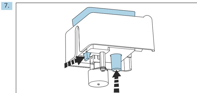
Spingere fuori la cuvetta dal basso premendo simultaneamente la linguetta e l'attacco del tubo flessibile.
