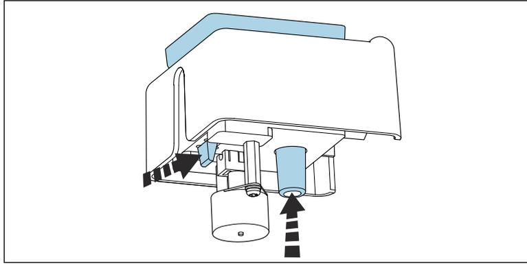
Spingere fuori la cuvetta dal basso premendo simultaneamente sulla linguetta e l'attacco del tubo.
