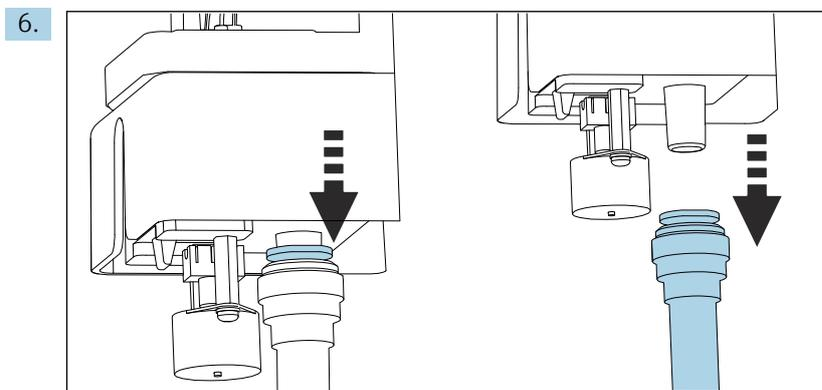
Rimuovere il tubo flessibile di scarico "W".
