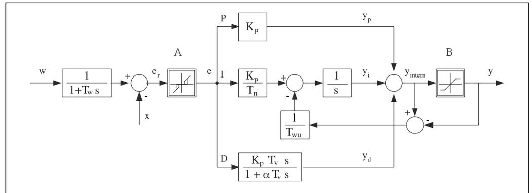
71 Diagramma a blocchi della struttura del controllore
