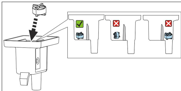
Inserire di nuovo l'ancoretta magnetica nella camera di misura, verificando che sia in posizione piatta.
