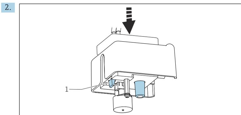
Spingere la cuvetta con l'ancoretta magnetica e il coperchio nel supporto. Verificare che la linguetta (1) sia innestata correttamente.
