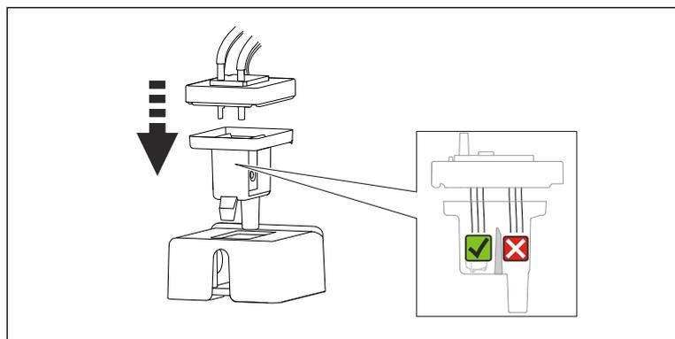
Riposizionare il coperchio in gomma sulla cuvetta e verificare che tutti i capillari siano nella camera di misura.
