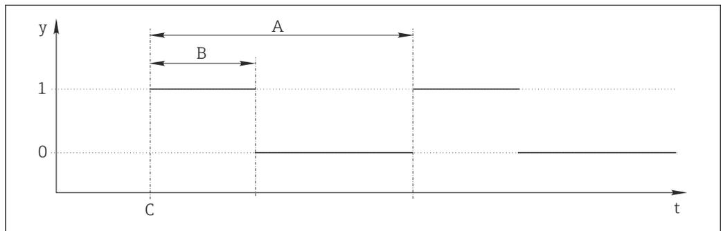
69 Schema del segnale di un commutatore a tempo
