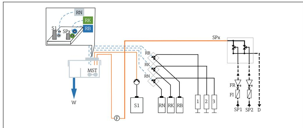
59 Schema di connessione dei tubi flessibili per versione a 1/2 canali
