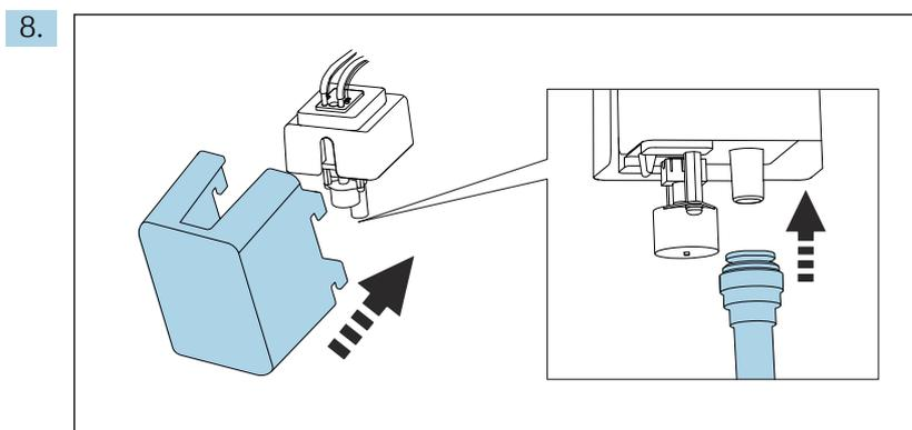
Ricollegare il tubo di scarico "W" e fissare di nuovo il coperchio.
