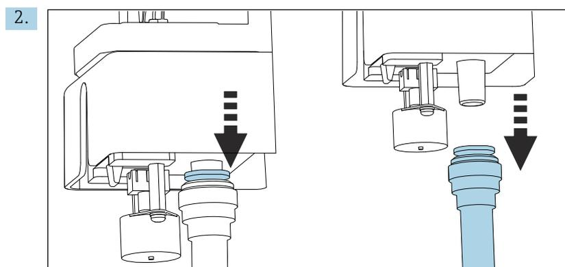
Rimuovere il tubo flessibile di scarico "W".
