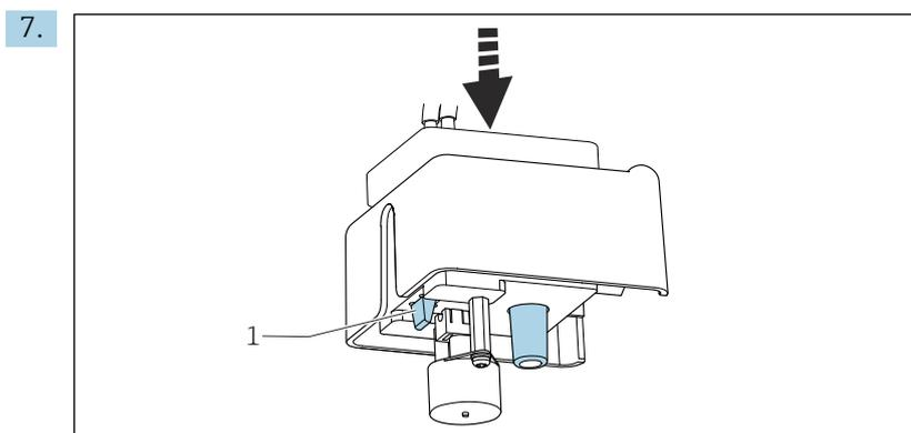
Spingere la cuvetta con l'ancoretta magnetica e il coperchio nel supporto. Assicurarsi che la linguetta (1) si innesti correttamente.
