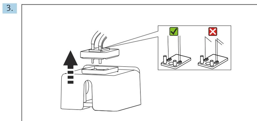
Sollevare e togliere il coperchio in gomma della cuvetta. I capillari non devono essere piegati in prossimità del relativo supporto o delle valvole e non devono essere smontati dal connettore del tubo flessibile.
