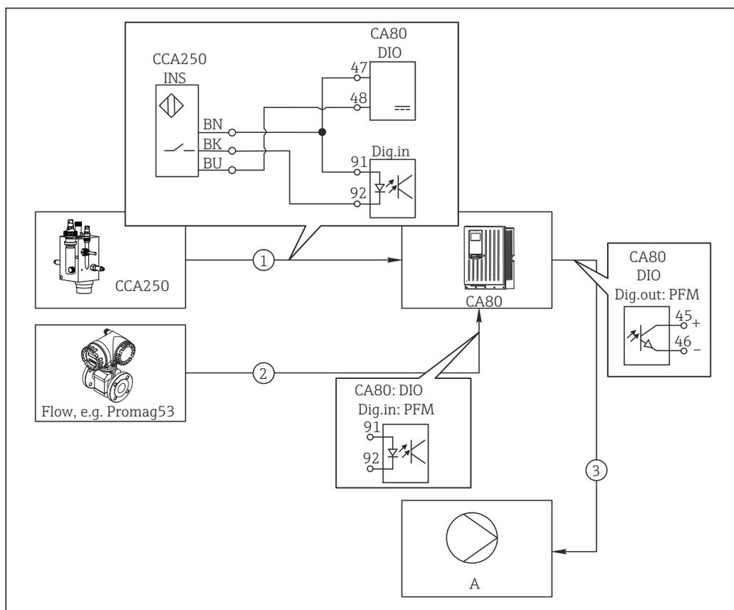
61 Esempio di controllo feedforward del cloro
