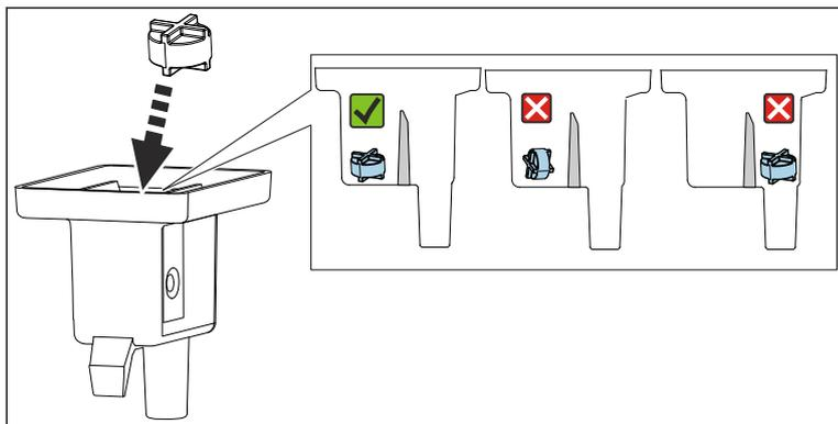
Posizionare l'ancoretta magnetica nella camera di misura, verificando che sia in posizione piatta e all'interno della camera di misura.
