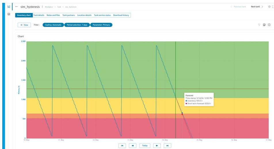
**i** A exibição da previsão de curto prazo fica desabilitada por padrão. A previsão de curto prazo e seu período de tempo são ativados pela Endress+Hauser. Para exibir a previsão de curto prazo para um tanque específico, a previsão de curto prazo também deve ser ativada no menu Configuração → Tanque na guia **Detalhes do tanque**.
