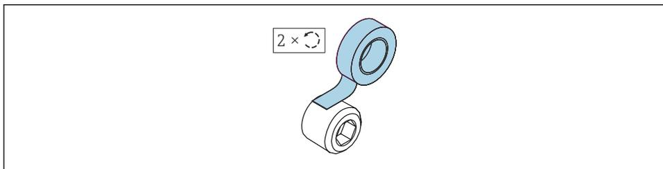
Nur erforderlich, wenn Blindstopfen NPT $\frac{1}{2}$  und NPT $\frac{3}{4}$  nicht mit PTFE-Dichtband vormontiert.
