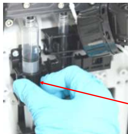
Spritzenhalter-Oberteil zum aufschnappen Dispenser holder top as a snap-on lid
