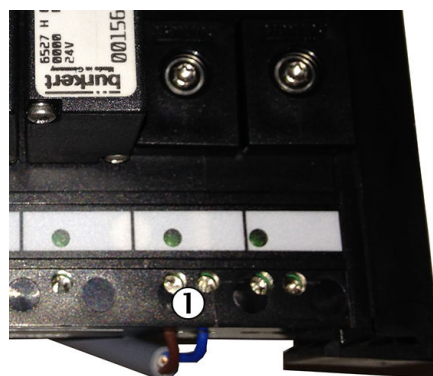
Figura 93: Cavo sul gruppo valvole
