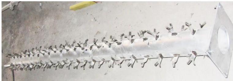
Abb. 21: Schutzrohr mit angeschweißten Verankerungsmetalteilen
