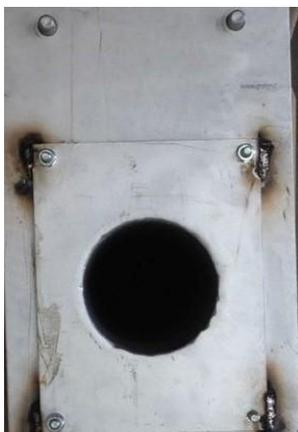
Abb. 22: Schutzrohrflanschplatte mit Montageplatte verschweißt
