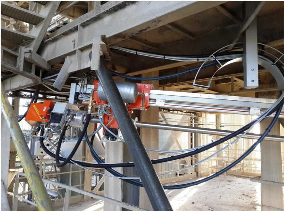
Abb. 37: Sonde mit vollständig installierter Kabel- und Schlauchvorrichtung (Beispiel)
