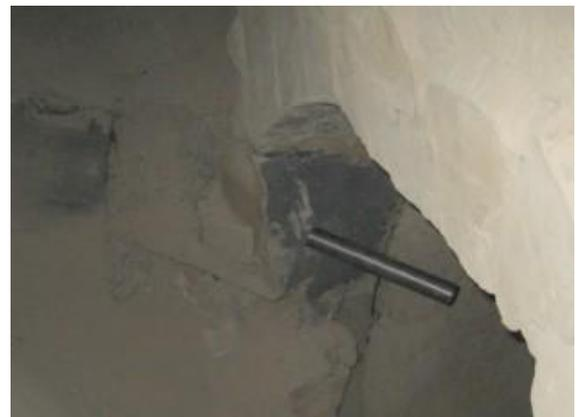
Abb. 24: Mit Feuerbeton bedecktes Schutzrohr im Inneren des Drehrohrofens (Beispiel)
