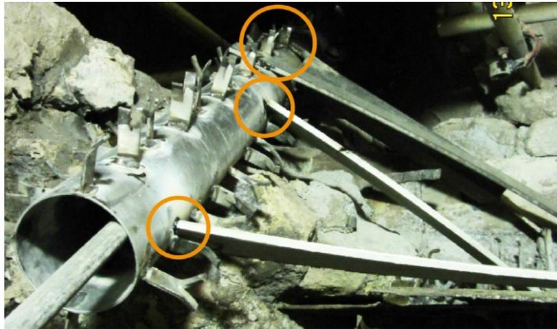
Abb. 23: Schutzrohr im Inneren des Drehrohrofens mit Stabilisierungsmaterial gesichert
