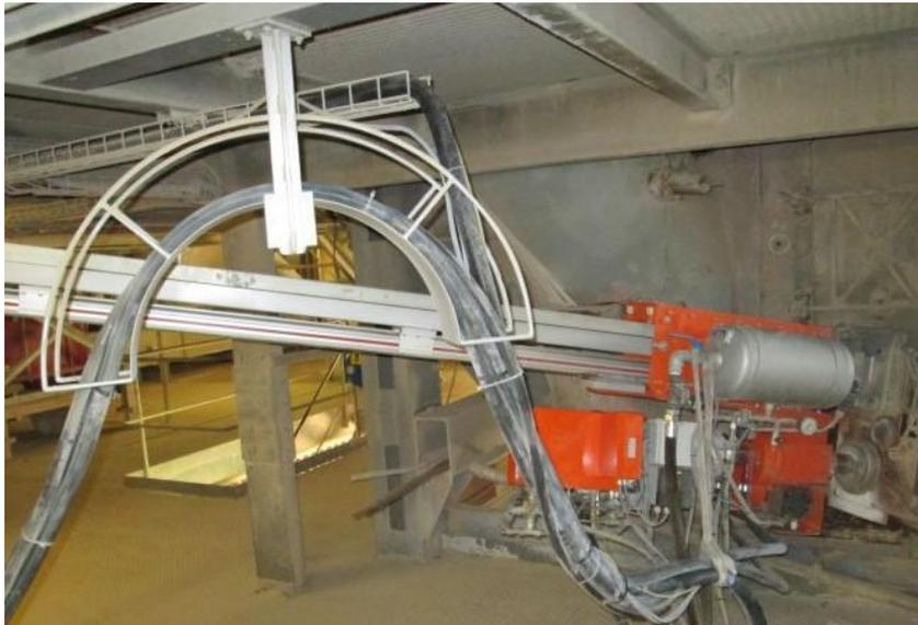
Abb. 30: An der Decke montierte Schlauchhalterung (Beispiel)
