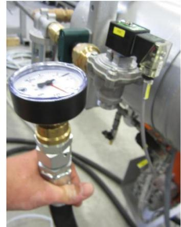
Abb. 55: Verschlussklammer - Manometer
