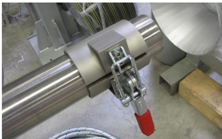
Abb. 50: Geschlossene Verschlussklammer
