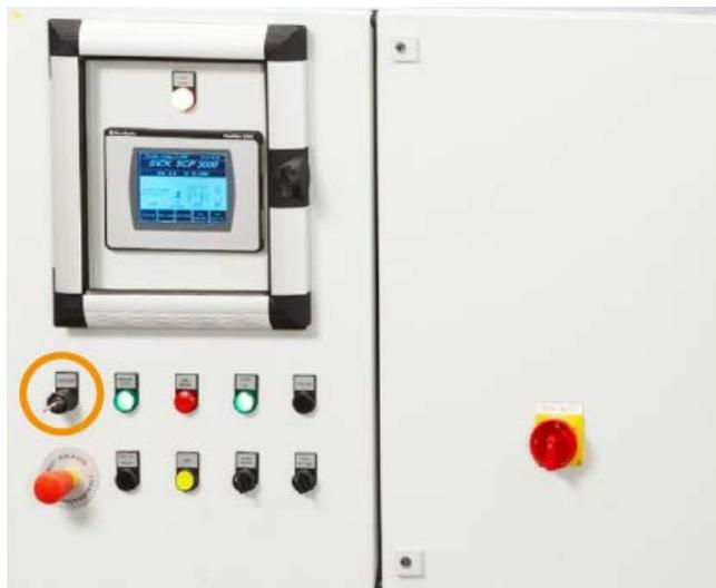
Abb. 49: Schaltschrank - Schlüsselwahlschalter
