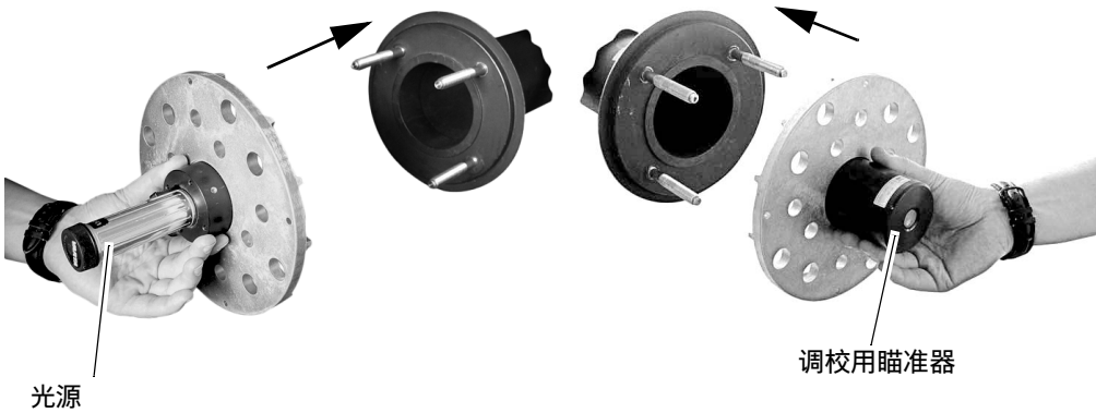
图 5：使用光学调校设备给法兰准直
