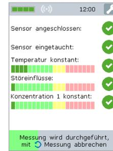
Das Messgerät prüft die Messbedingungen.
