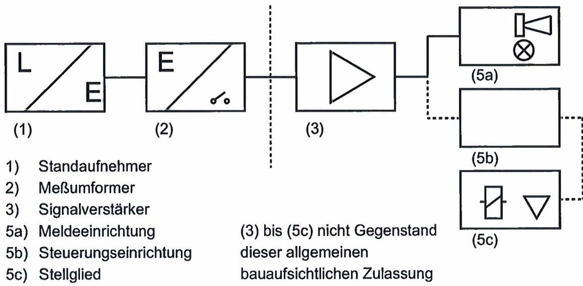
Standaufnehmer (Verdränger) mit angebautem Messumformer als Standgrenzschalter von Überfüllsicherungen
