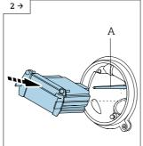
Das Elektronikmodul beim Einbau entlang der Führungsschiene (A) im Messumformergehäuse einschieben.
