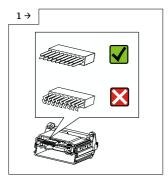
► Vor dem Einbau die Stiftleiste des Elektronikmoduls überprüfen. Die Pins dürfen nicht verbogen sein.
