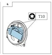
· Schrauben des Elektronikmoduls festziehen.
