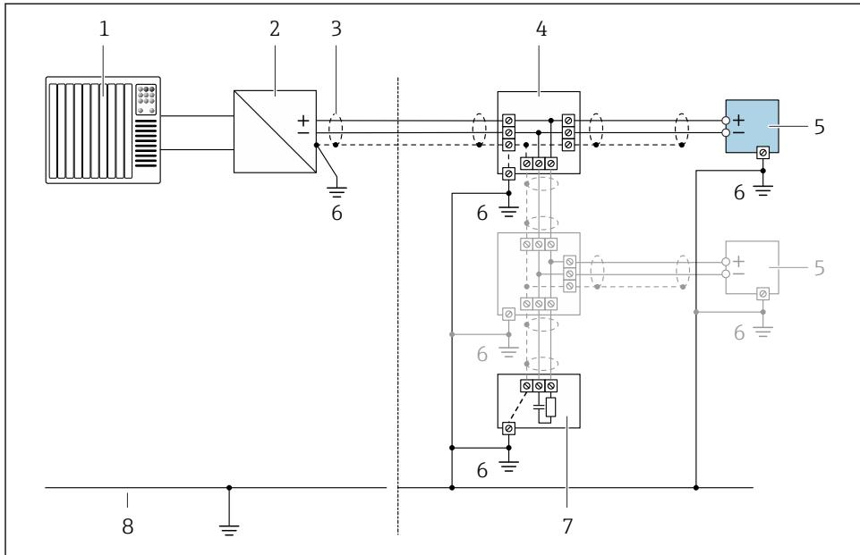
图 3 FOUNDATION Fieldbus 的接线实例
