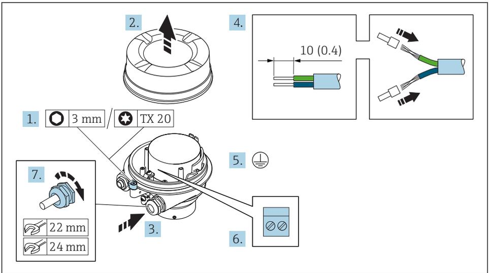
1. Sicherungskralle des Gehäusedeckels lösen.
