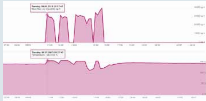
Datenaufzeichnung beim Verladen von Bitumen in Tankwagen. Dargestellt sind Massefluss (oben) und Temperatur (unten).
