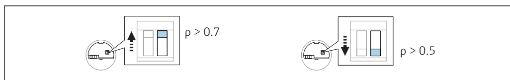
43 Położenie przełącznika gęstości na module elektroniki
