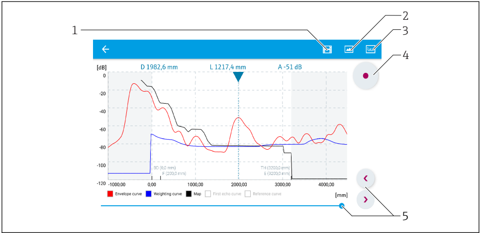
18 Burkológörbe megjelenítése (példa) a SmartBlue-ban; Android nézet
