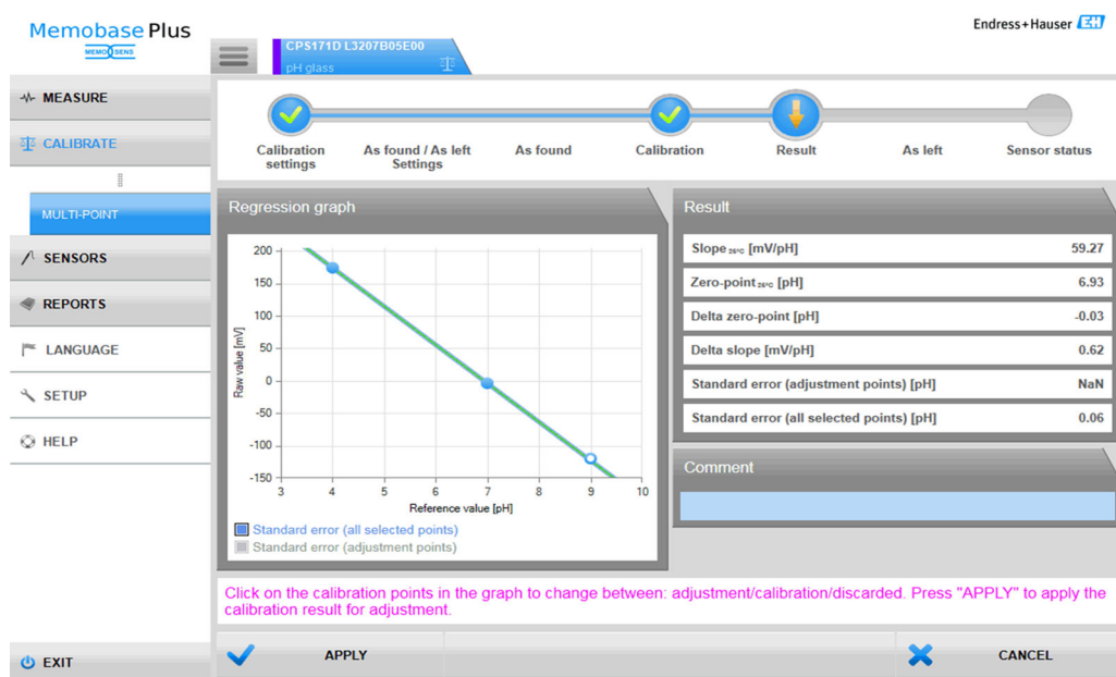
16 Kalibracja wielopunktowa: bufor 4 i 7 wybrano jako punkty dopasowania, bufor 9 jako punkt kalibracji
