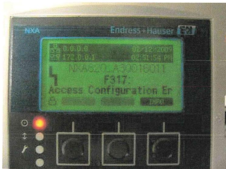
Abb. 25: Fehlermeldung, kein PC am System registriert
