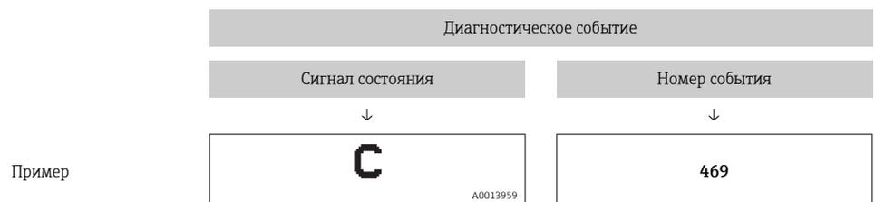
Если в очереди на отображение одновременно присутствуют два или более диагностических события, то выводится только сообщение с максимальным приоритетом.
