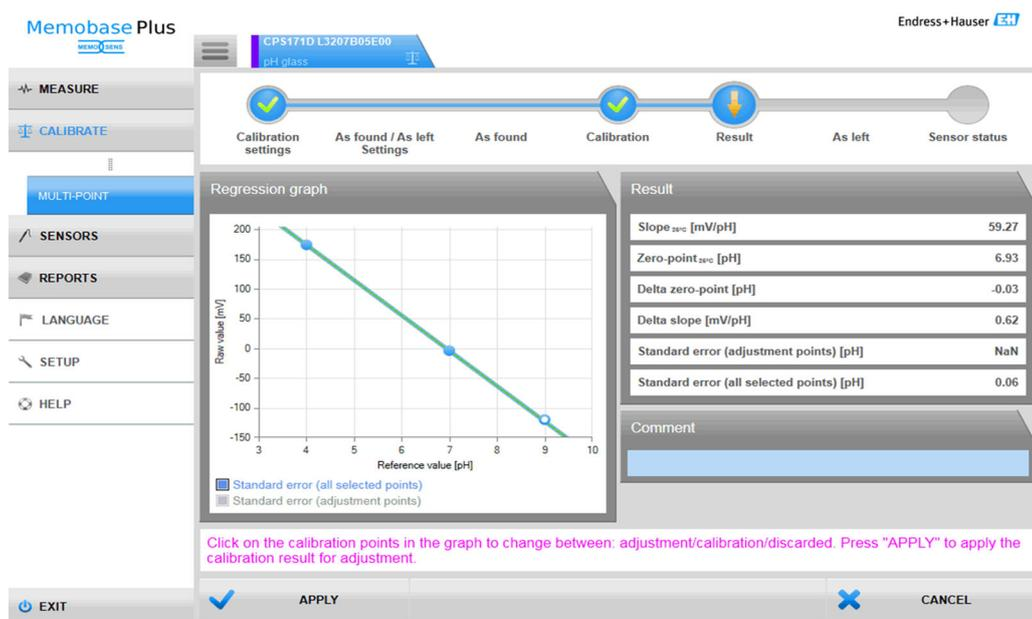
**16** Многоточечная калибровка: в качестве точек коррекции выбраны буферные растворы 4 и 7, в качестве точки калибровки – буферный раствор 9
