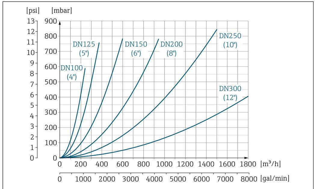
47 Perdita di carico DN 100 ... 300 (4 ... 12") per codice d'ordine per "Design", opzione C "Flangia fissa, senza tratti rettilinei in entrata/uscita"
