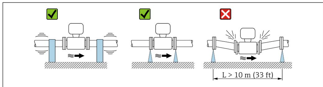
8 *Accorgimenti per evitare la vibrazione del dispositivo*
