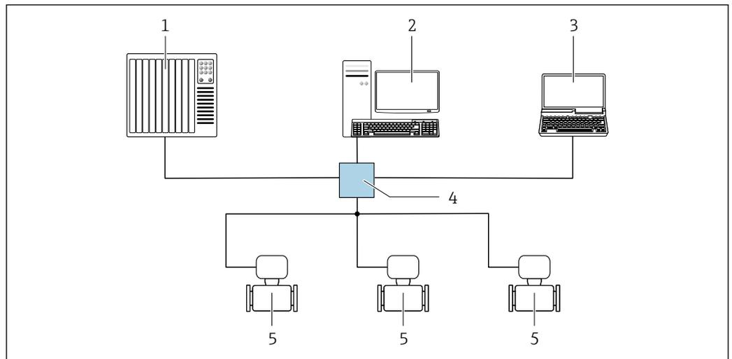
34 Opzioni per il funzionamento a distanza mediante rete EtherNet/IP: topologia a stella
