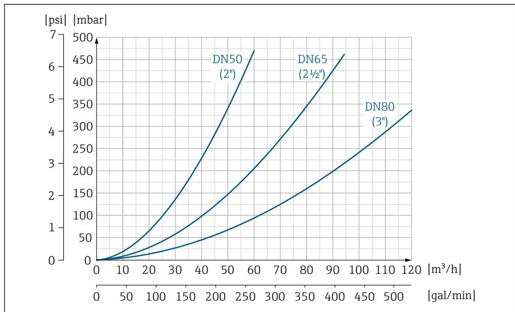
46 Perdita di carico DN 50 ... 80 (2 ... 3") per codice d'ordine per "Design", opzione C "Flangia fissa, senza tratti rettilinei in entrata/uscita"
