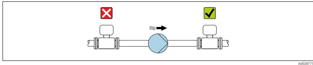
Non installare mai il sensore sul lato di aspirazione della pompa per evitare il rischio di bassa pressione e, quindi, di danneggiare il rivestimento.
