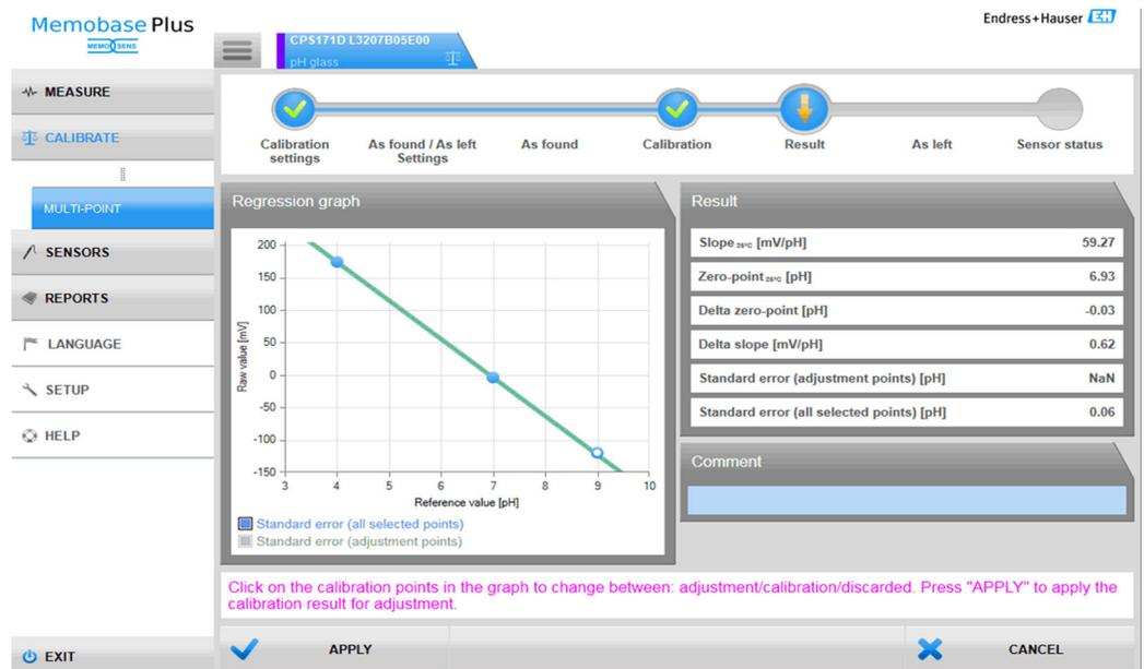
**16** *Étalonnage à points multiples : tampons 4 et 7 sélectionnés comme points d'ajustage, tampon 9 comme point d'étalonnage*
