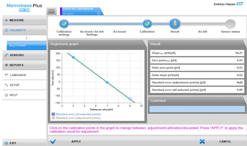
4 Etalonnage à points multiples (licence "Diagnostic étendu") : tampons 4 et 7 sélectionnés comme points d'ajustage, tampon 9 comme point d'étalonnage
