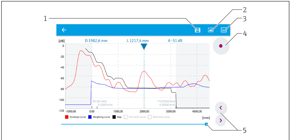
20 Przykład krzywej obwiedni echa wyświetlanej w aplikacji SmartBlue dla systemu Android
