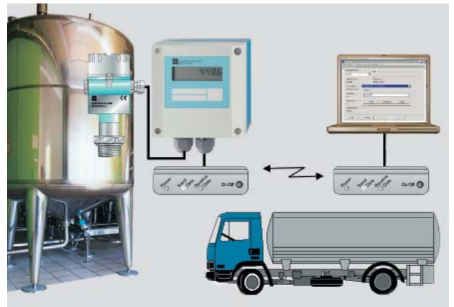
Medición de nivel de melazas en depósitos específicos de cliente de un proveedor. El Minilog B almacena el uso del cliente e informa al proveedor sobre el nivel actual en el depósito de almacenamiento. Los datos se recogen en un punto de suministro central y están disponibles para la planificación de las entregas en el momento justo.
