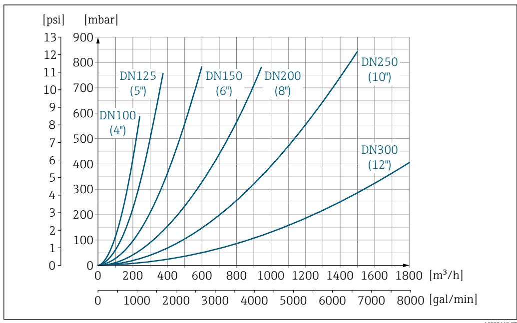
35 Perda de pressão DN 100 a 300 (4 a 12") para código de pedido para "Design", opção C "flange fixa, sem operações de entrada/saída"
