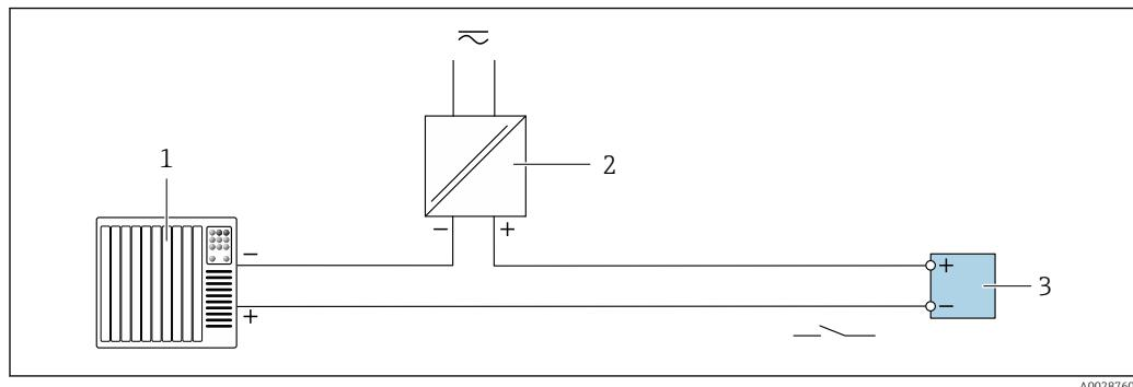
15 Exemplo de conexão para saída comutada (passiva)
