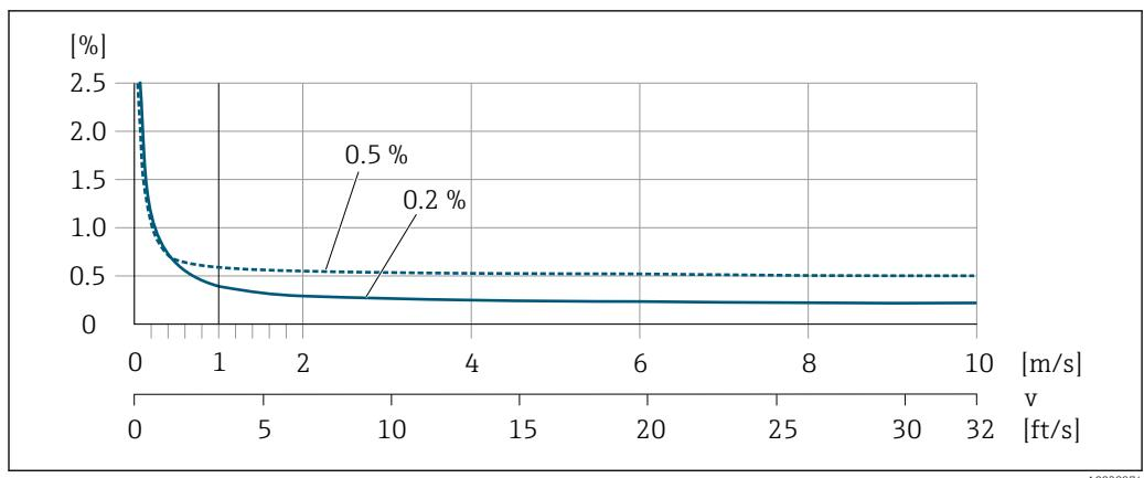
Fig. 32 Erro máximo medido em % d.l.
