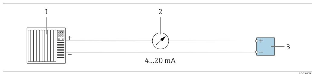
■ 12 Exemplo de conexão para saída de corrente 4-20 mA (ativa)
