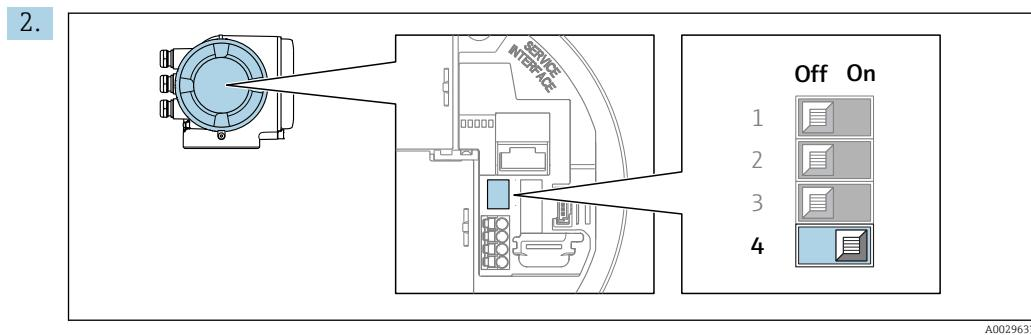
Para comutar o endereçamento do endereçamento de software para o endereçamento de hardware: coloque a minisseletora em **On**.
