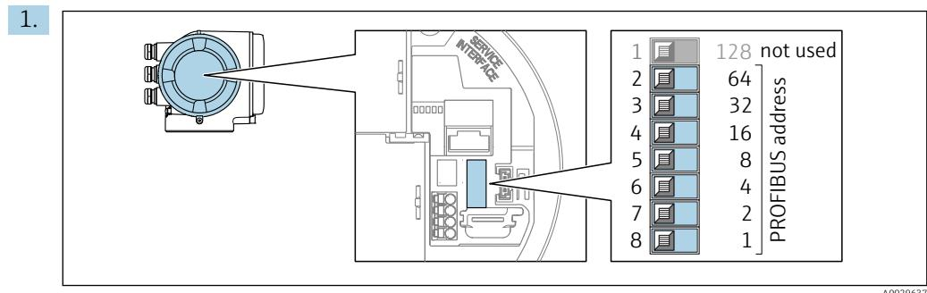
Ajuste o endereço do equipamento desejado, utilizando as minisseletoras no compartimento de conexão.
