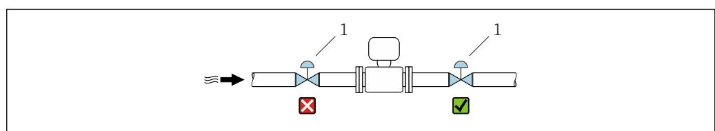
**■ 4** Não é recomendada a instalação do sensor após um controle de válvula
