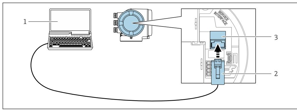
24 Conexão através de Interface de operação (CDI-RJ45)
