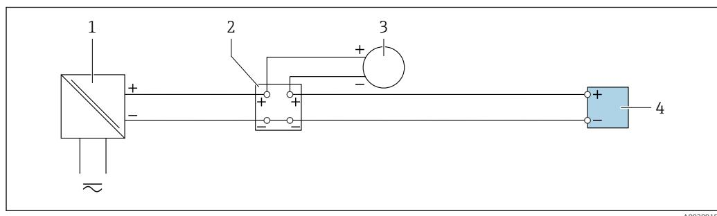
17 Exemplo de conexão para entrada em corrente de 4 a 20 mA
