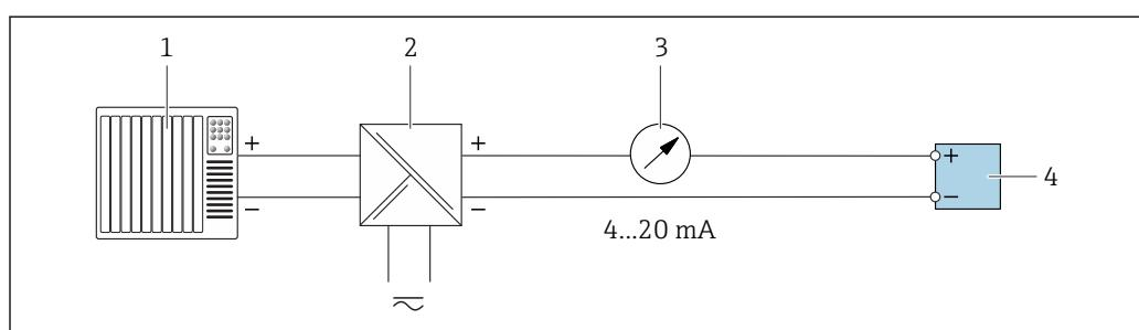
图 12 4...20 mA 电流输出 (无源) 的连接示例
