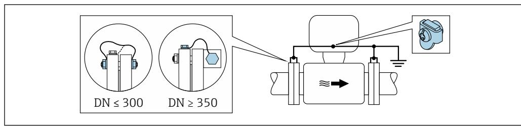
图 8 通过接地端子和管道法兰实现电势平衡
