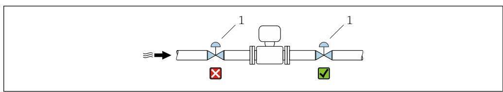
图 3 不建议将传感器安装在控制阀后方。
