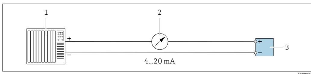
图 11 4...20 mA 有源电流输出的连接示例
