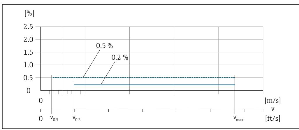
图 32 指定测量精度 (% o.r.)
