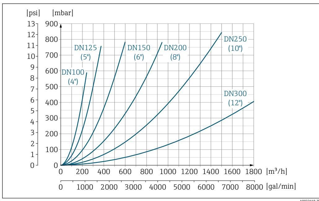
图 34 压损：适用口径 DN 100...300 (4...12"); 订购选项“设计”，选型代号 C “固定法兰，无前后直管段”
