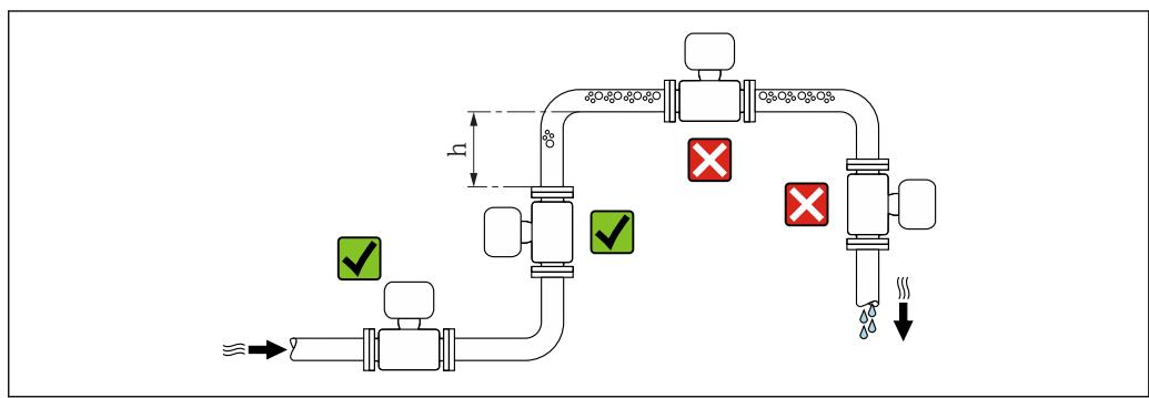
建议将传感器安装在介质自下向上流动的管道中，并确保与相邻管道弯头间预留有足够的间距： $h \geq 2 \times DN$ 。
