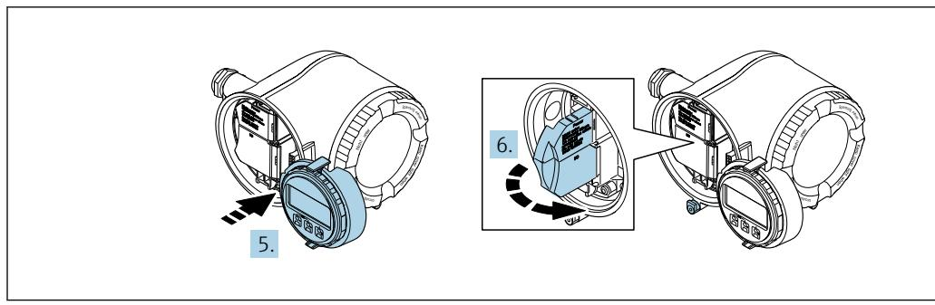
5. 将支架安装在电子腔边缘。
