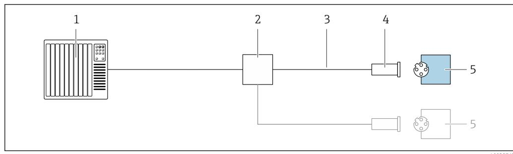
图 10 工业以太网(EtherNet/IP)的连接实例
