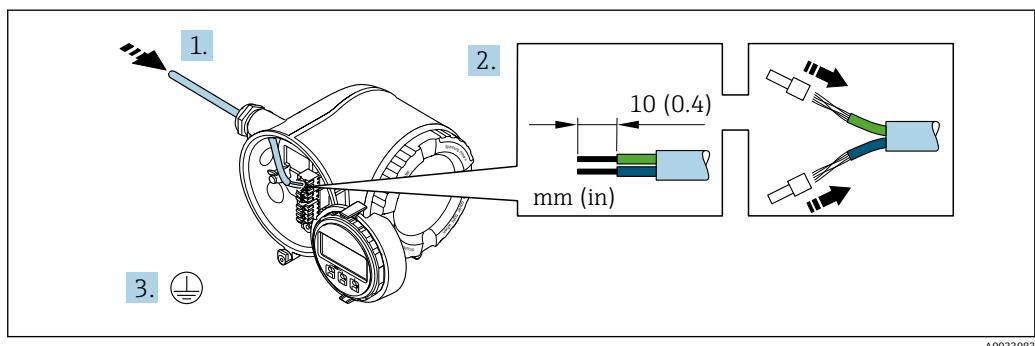
1. 将电缆插入至电缆入口中。禁止拆除电缆入口上的密封圈，确保始终牢固密封。
