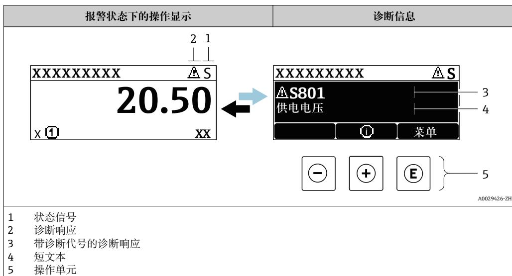
同时出现两个或多个诊断事件时，仅显示优先级最高的诊断事件信息。
