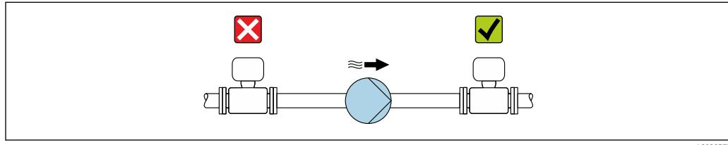
禁止将传感器安装在泵的入口侧，避免低压损坏测量管内衬。
