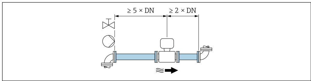
如果在订购选项“设计”中选择选型代号 C “固定法兰”，此类传感器无需考虑前后直管段长度。
