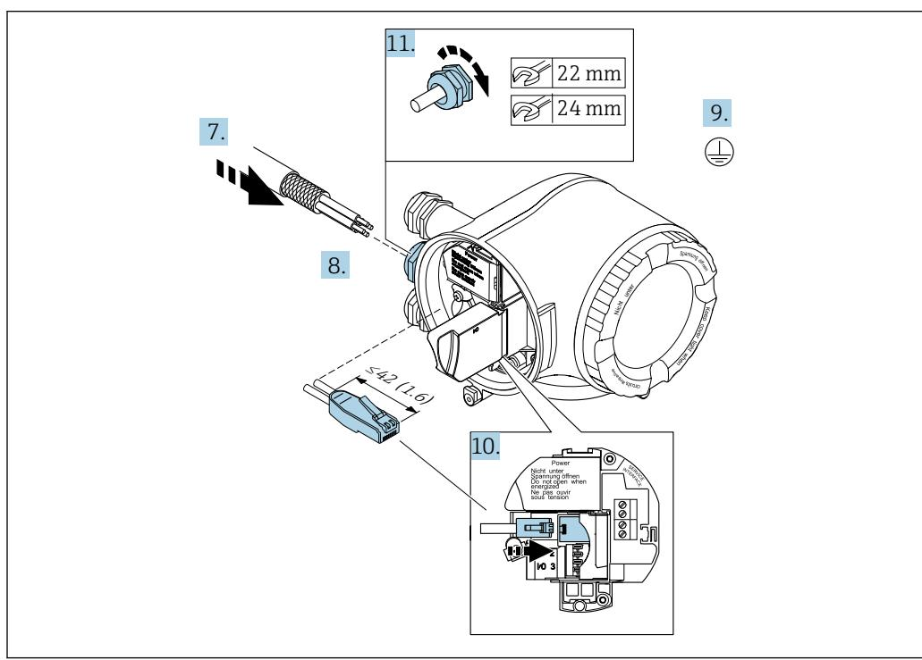
7. 将电缆插入至电缆入口中。禁止拆除电缆入口上的密封圈，确保始终牢固密封。
