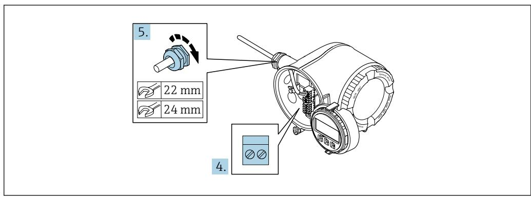
4. 参照接线端子分配连接电缆。
