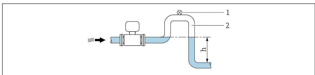
图 4 在竖直向下管道中安装
