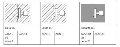
L'appareil est conçu pour le fonctionnement en atmosphère gazeuse ou poussiéreuse explosive comme indiqué dans le schéma ci-dessus. En cas d'apparition simultanée de mélanges gaz-air et poussière-air potentiellement explosifs : une évaluation plus poussée de la conformité est nécessaire.
