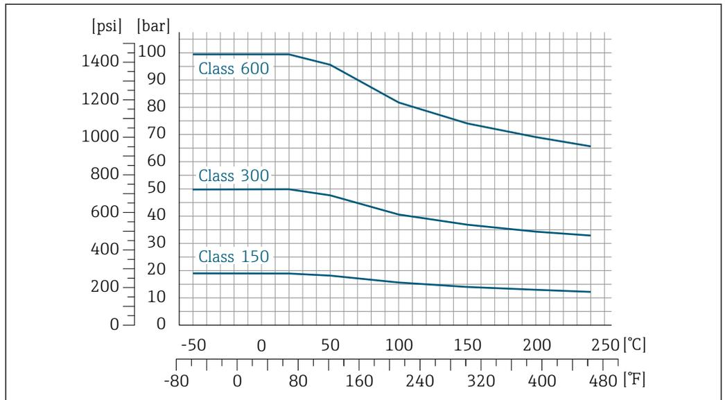
30 Mit Flanschwerkstoff 1.4301 (F304); mediumsberührende Teile Alloy C22
