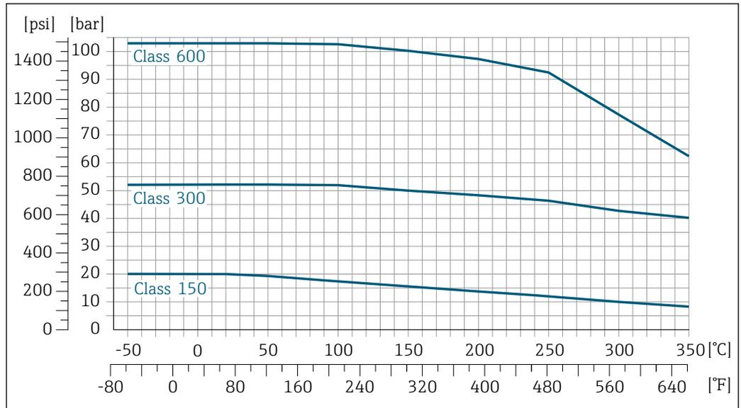
26 Mit Flanschwerkstoff Alloy C22
