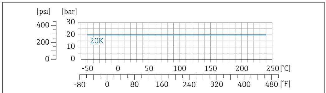
31 Mit Flanschwerkstoff 1.4301 (F304); mediumsberührende Teile Alloy C22
