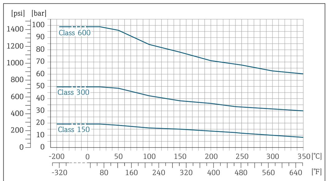
25 Mit Flanschwerkstoff 1.4404 (F316/F316L)
