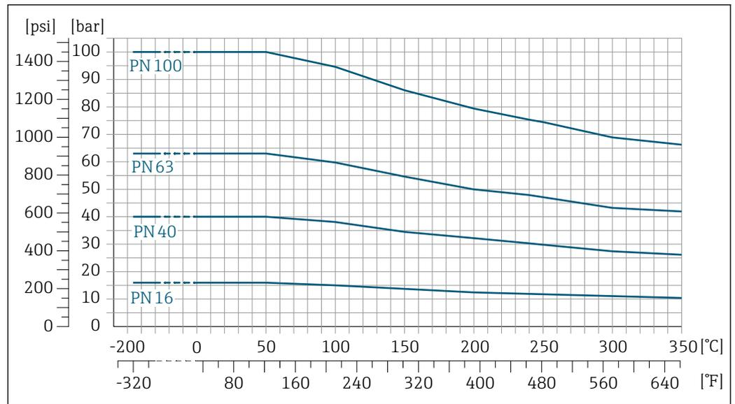
24 Mit Flanschwerkstoff 1.4404 (F316/F316L), Alloy C22
