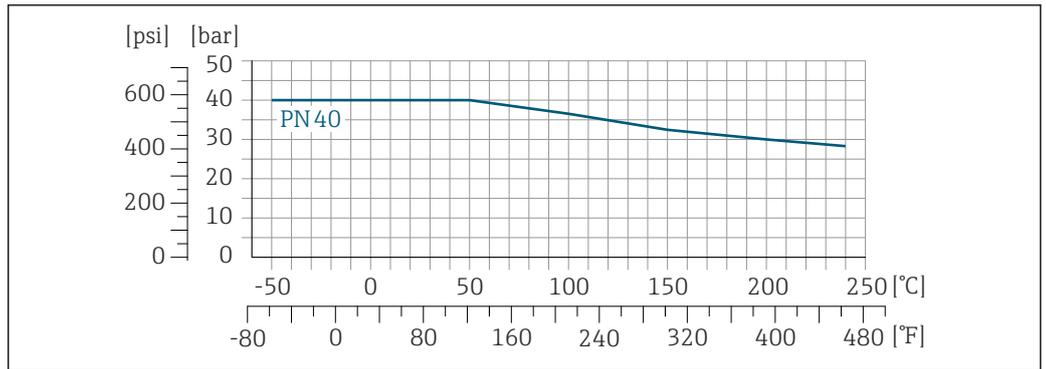
29 Mit Flanschwerkstoff 1.4301 (F304); mediumsberührende Teile Alloy C22
