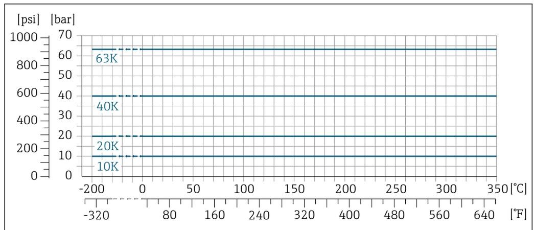
27 Mit Flanschwerkstoff 1.4404 (F316/F316L), Alloy C22
